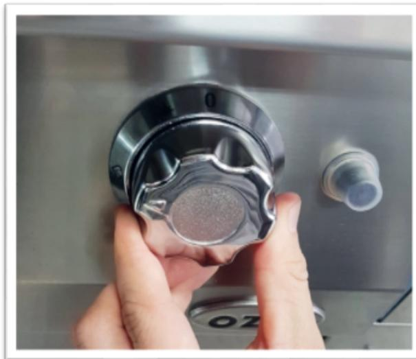
5) Para apagar gire la válvula a la derecha hasta donde está la chispa
